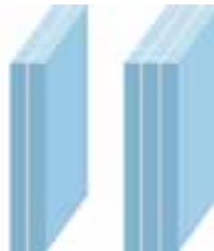
Figure 8 : Schéma d'un vitrage simple feuilleté de type 44.2 (à gauche) et 666.4 (à droite)
