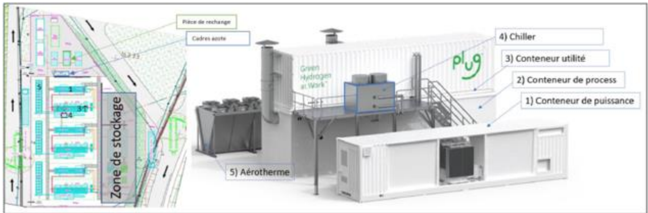
Figure 28 – Illustration de modules d'électrolyseurs conteneurisés (source : INGEROP)
