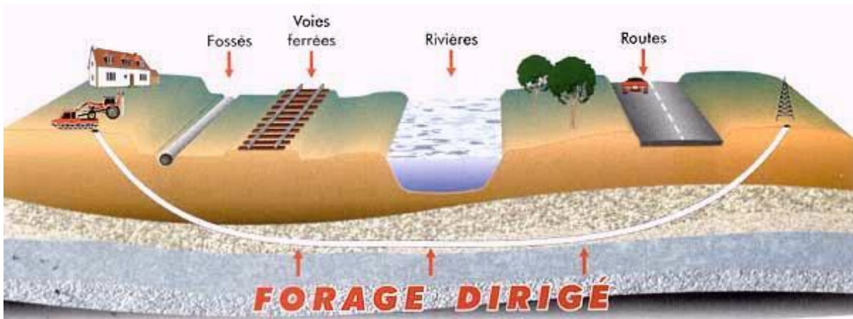
Figure 29 – Principe du forage horizontal dirigé
