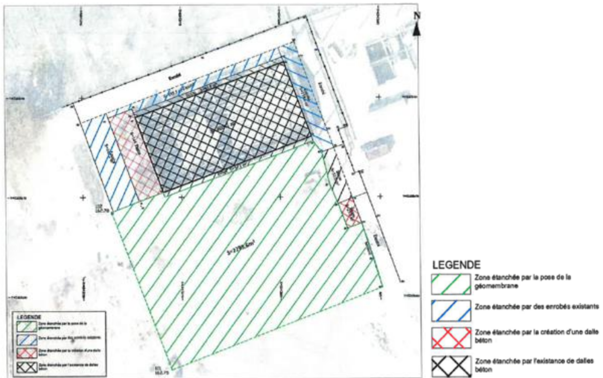
Figure 26 – Bilan des surfaces étanchées de la Zone Arsenicaux (source : plan de gestion de la pollution Arcadis, 2012)
