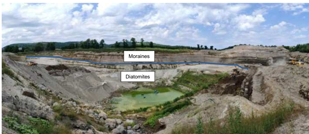
illustration 4 -Vue générale de la carrière vers le nord avec vue sur les moraines qui reposent sur les diatomites
