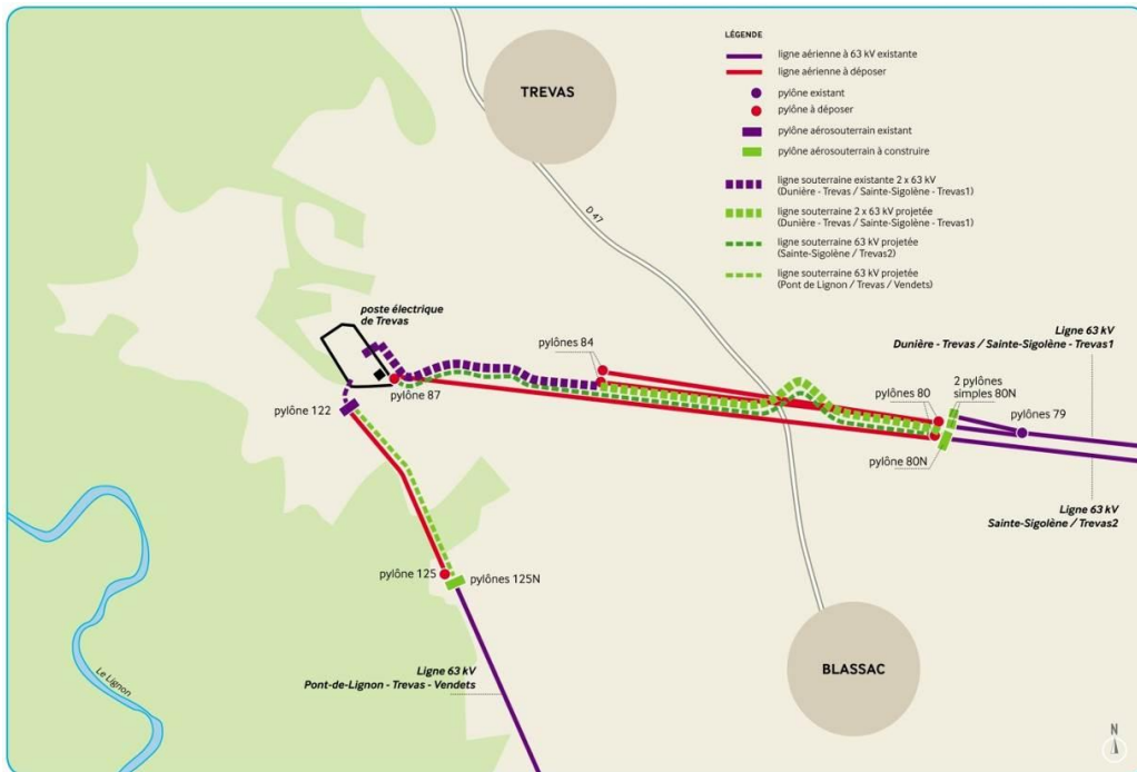
Mise en souterrain partielle des lignes électriques aériennes 63 000 volts au poste de Trevas © RTE
