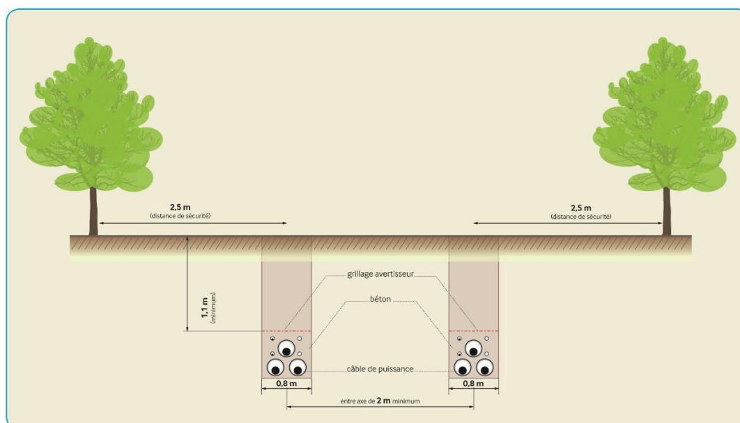
Coupe schématique du principe d'une liaison souterraine à deux circuits, pose en fourreau © RTE, 2013
