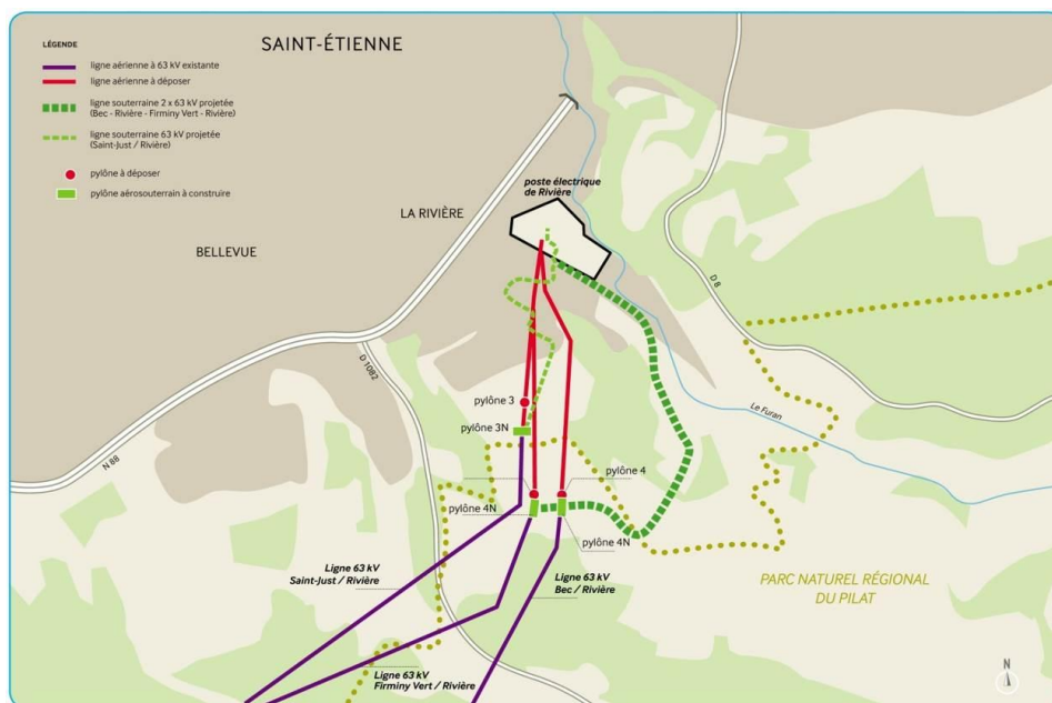
Mises en souterrain partielles des lignes électriques aériennes 63 000 volts au poste de la Rivière © RTE
