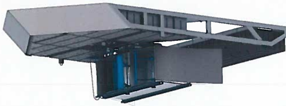
Figure 1-2. Hydrolienne un étage sur barge flottante en position de fonctionnement
