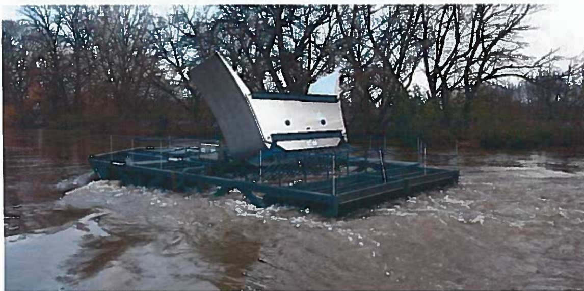
Figure 1-12. Hydrolienne HYDROQUEST RIVER 1.40 sur son site d'exploitation, en position remontée
