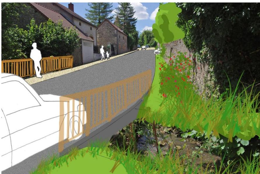
Traversée valorisée et bien marquée par des garde-corps visibles. Surrélévation de 50cm environ pour le passage du ruisseau. Elargissement pour permettre la création d'un trottoir piéton.
