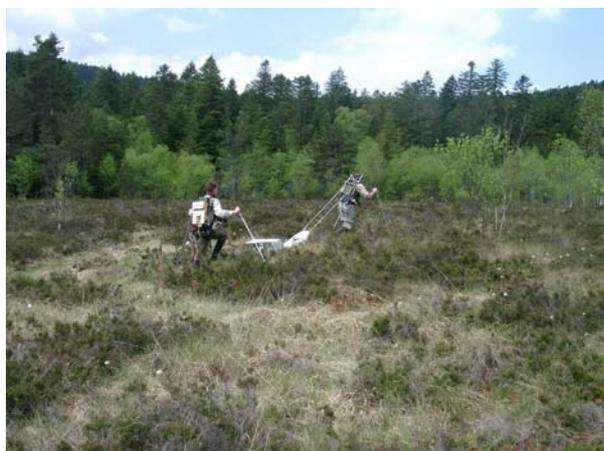
U5 : Enregistrement par ondes radar de l'épaisseur de tourbe. (Elle serait supérieure à 5 m de profondeur par endroit dans la tourbière de la croix de l'olivier). Photo EM
