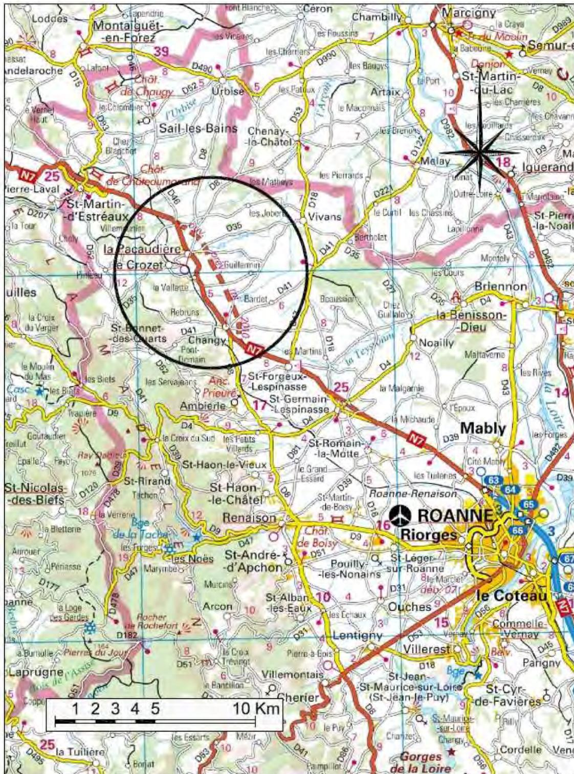
Les principaux travaux de l'opération « RN7 – déviation de La Pacaudière et Changy » se sont achevés avec la mise en service le 30 juin 2010 de la déviation. Elle s'étend sur un tracé neuf de 8,9 km à 2x2 voies limité à 110 km/h avec un rabattement progressif au nord (commune de La Pacaudière) et au sud (commune de Changy) afin de se raccorder sur les deux voies de la RN7 existante.
