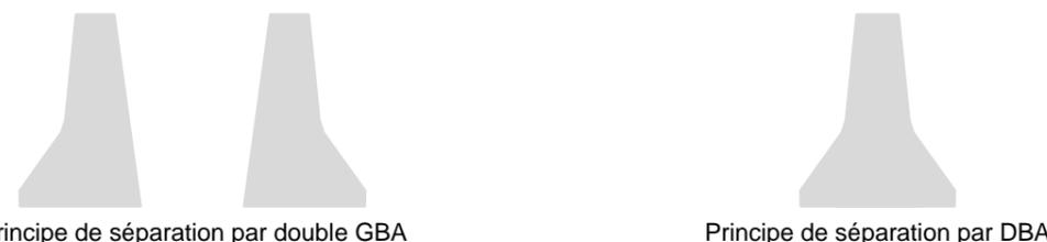
Figure 8 : Principes étudiés pour le dispositif de retenue des véhicules sur le terre-plein central
