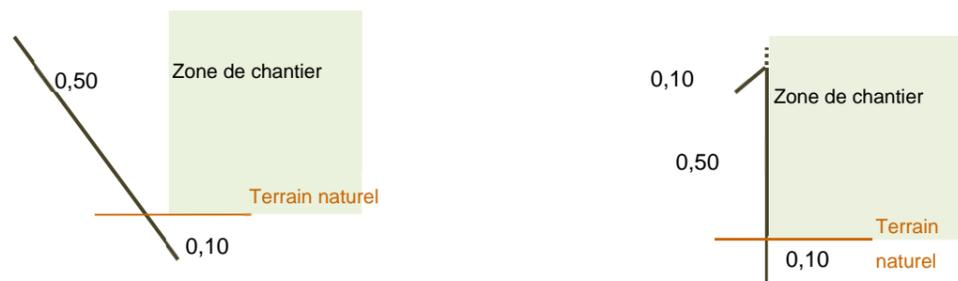
**Figure 36 : Principe et caractéristiques des clôtures contre l'intrusion des batraciens. Source : Arcadis**
