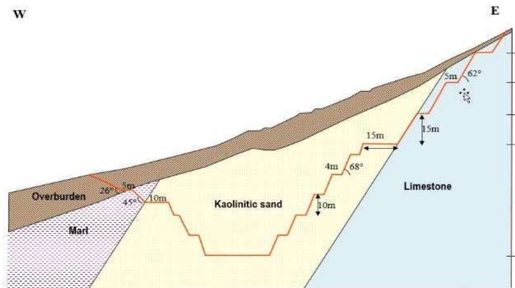
Figure 58 -Vue en coupe du gisement de kaolinite qui montre le débordement de l'exploitation en gradins de part et d'autre des 'épointes' du gisement.(source :BRGM RP-70630 provisoire, mars 2021)
