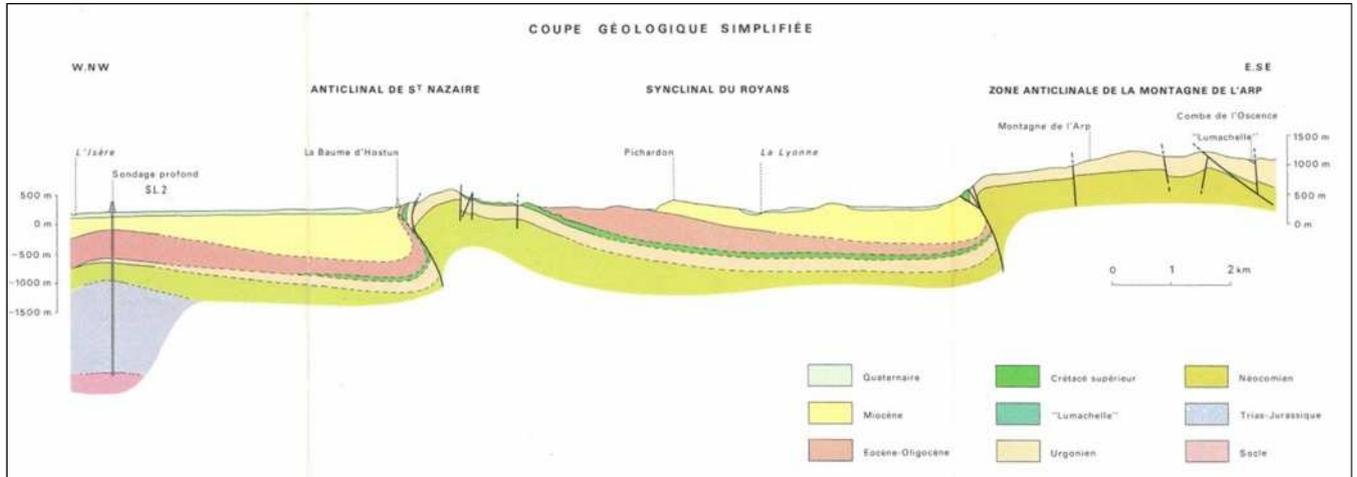
Figure 56 - Coupe géologique simplifiée (carte BRGM 1/50 000<sup>ème</sup>) montrant le gisement kaolinisé à l'ouest de l'anticlinal de St Nazaire et le gisement feldspathique à l'est. (source :BRGM RP-70630 provisoire, mars 2021)
