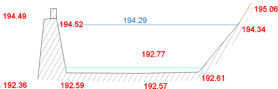
Figure 32 : Réhausse parapet PK 1619
