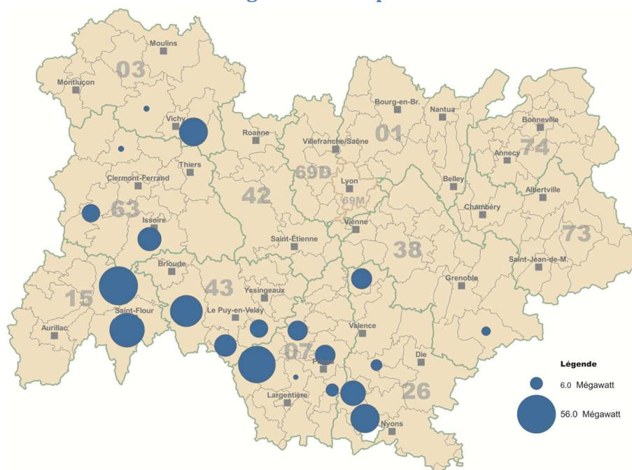
**Puissance installée de production d'électricité hydraulique
