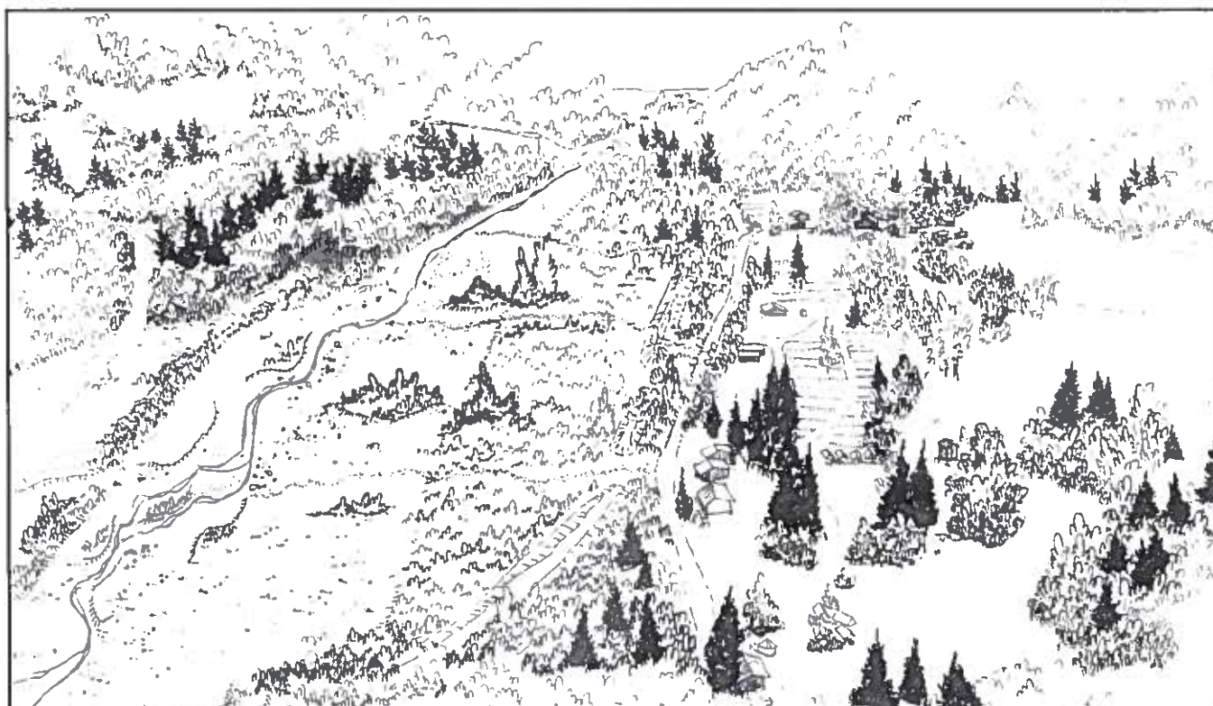
Vue axonométrique de l'état projeté après aménagement d'une plage de dépôt pour le torrent du Nant Des Pères
